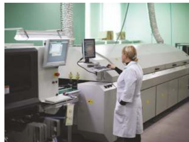
МОНТАЖ СВЕТОДИОДОВ НА ПЕЧАТНЫЕ ПЛАТЫ
